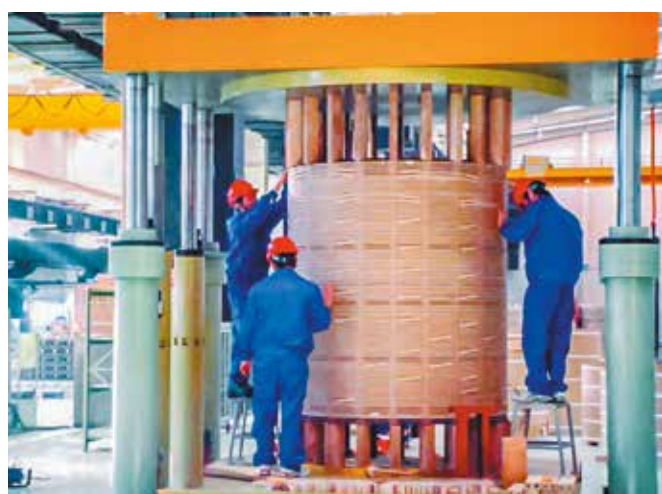
Пресс для изготовления обмоток с регулируемым усилием и высокой точностью позиционирования
