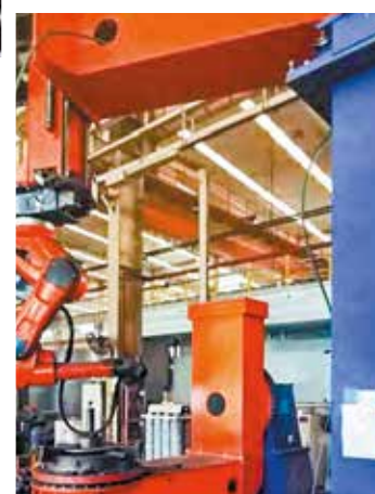
Сварочный робот для изготовления фланцевого основания
