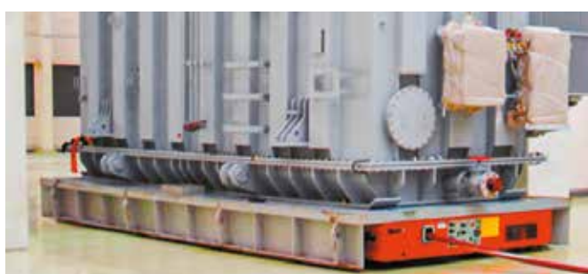
Платформа на воздушной подушке грузоподъемностью 260 т
