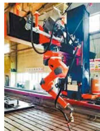
Сварочный робот для изготовления стенок масляного бака
