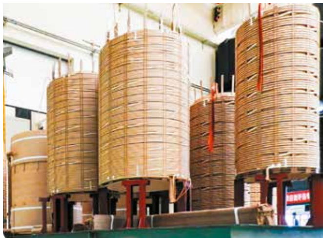
Сушка обмоток в парах керосина
