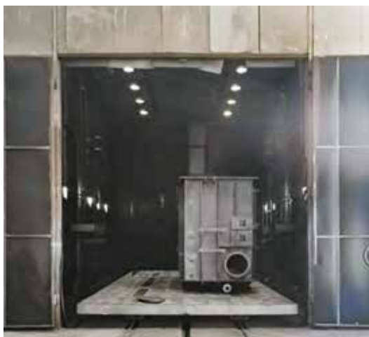
Помещение для пескоструйной обработки размером 18 м
