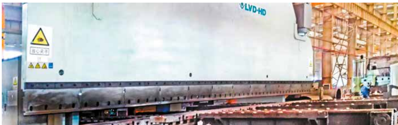
Гидравлический гибочный пресс с ЧПУ и усилием 1000 т
