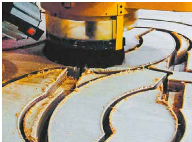
Комбинированный станок с ЧПУ для изготовления изоляции
