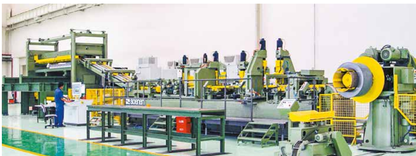
Линия поперечной резки Soenen (Бельгия)
